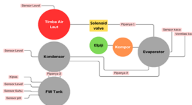
Figure. 1 Structural layout of Mini FWG
