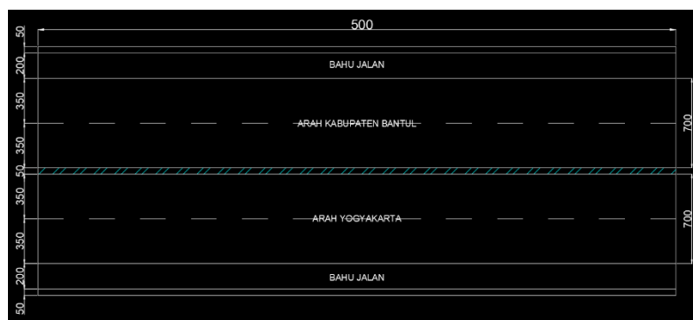
Gambar 8. Ilustrasi dimensi Jalan Bantul Km 7,5 – 8 (4/2-T standar)
