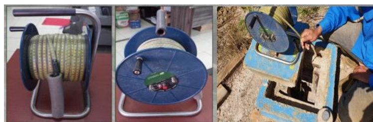
Gambar 12. Alat water level meter dan pengukuran di lapangan (sumber: dokumentasi lapangan)
