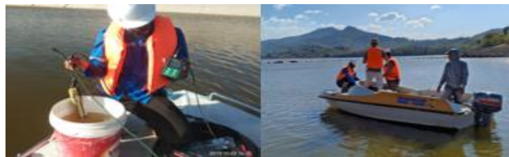
Gambar 6. Kalibrasi VW Piezometer dengan Metode Celup Danau (sumber: dokumentasi lapangan)
