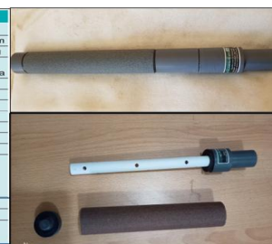
Gambar 11. Spesifikasi piezometer tip observation well (sumber: spesifikasi material)
