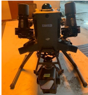
Gambar 5. UAV DJI Matrice 400 yang dilengkapi sensor LiDAR DJI Zenmuse L2.
