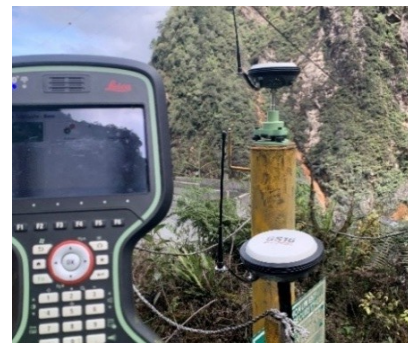
Gambar 4. Pengukuran koordinat GCP dan ICP menggunakan GNSS RTK Leica Viva GS16 dengan metode base-rover .
