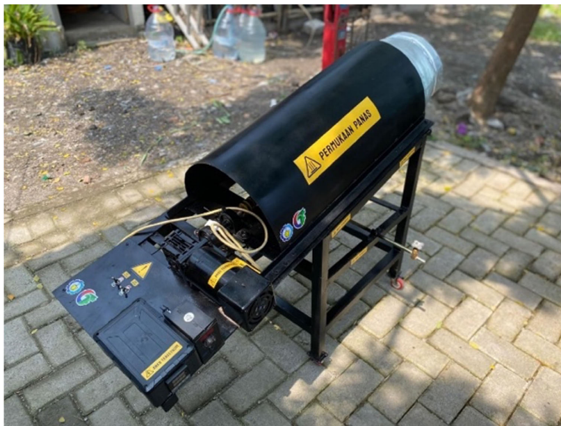
Gambar 7 Pemasangan stiker K3 sebagai bagian menurunkan risiko keselamatan kerja.
