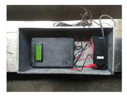
Gambar 7 Rangkaian alat sensor dan monitor yang dilengkapi aki.
