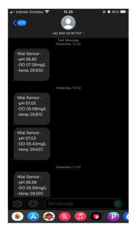
Gambar 8 Tampilan layar HP yang menerima SMS laporan pengukuran temperature, DO dan pH.
