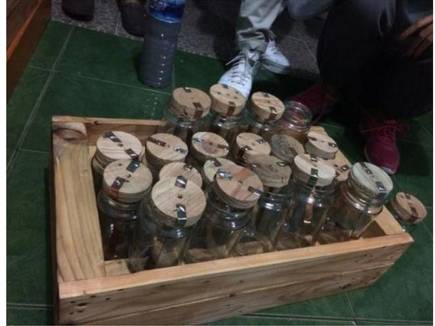
Fig. 6. Pembangkit listrik dari limbah *laundry* yang akan disusun secara seri.
