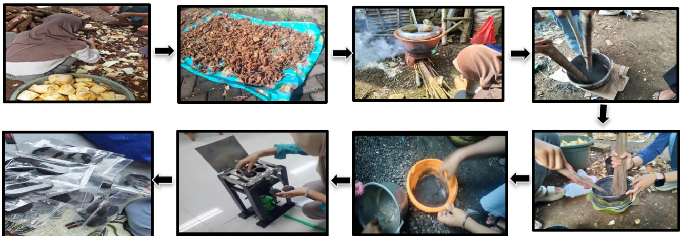
Gambar 4 Tahapan pembuatan biobriket kulit singkong.
