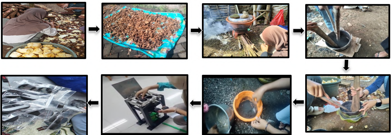
Gambar 4 Tahapan pembuatan biobriket kulit singkong.
