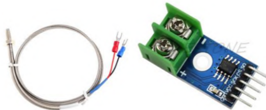
Gambar 3 Bentuk fisik termokopel dalam mesin pemanggang.
