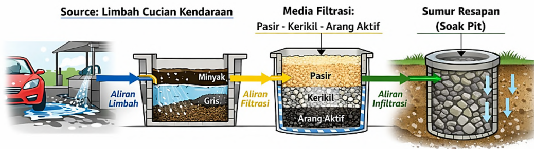
Gambar 2 Skema Konseptual Sistem Sumur Resapan dan Filtrasi Sederhana untuk Limbah Cair Bengkel.
