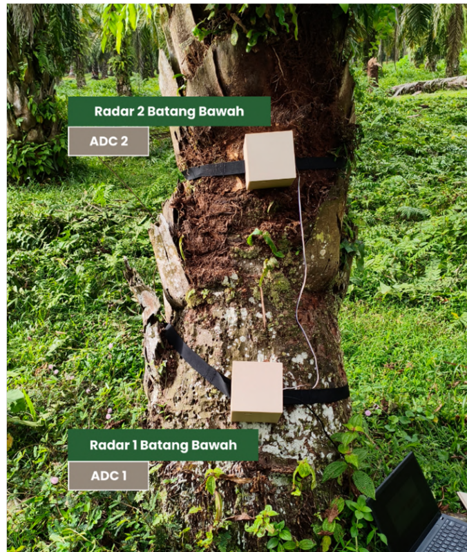
Gambar 8 Pemasangan Instrumentasi Radar Pada Pohon Sawit.
