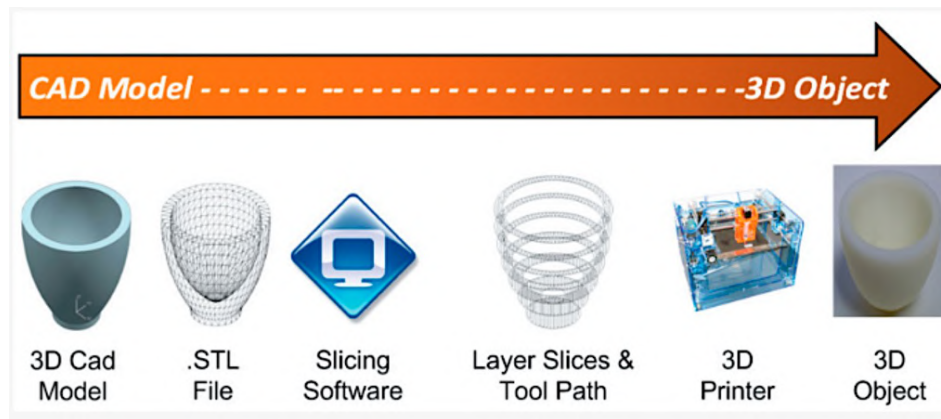
Gambar 1 Mekanisme fabrikasi dengan metode Fused Deposition Modelling [7] .
