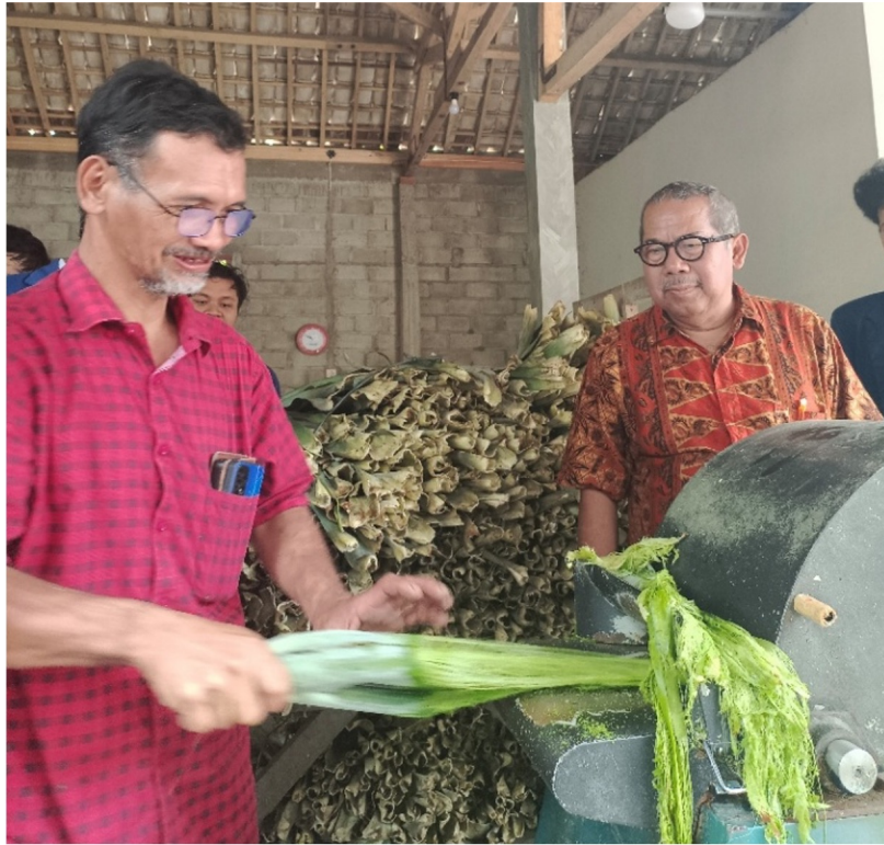
Gambar 11 Proses pengoperasian alat ekstraktor mekanik oleh anggota kelompok tani dalam pengolahan daun nanas menjadi serat.
