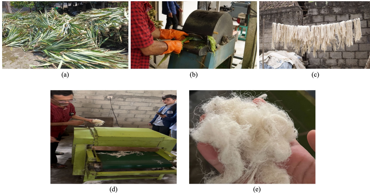
Gambar 3 (a) Limbah daun tanaman nanas sebagai bahan baku pengolahan serat, (b) Proses ekstraksi serat daun nanas menggunakan alat ekstraktor mekanik, (c) Produk serat kasar hasil proses ekstraksi mekanik, (d) Proses pengolahan serat kasar menjadi kapas menggunakan alat opening , (e) Produk kapas setelah proses penghalusan.
