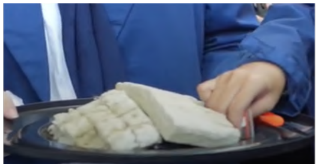
Gambar 10 Rockwool dibasahi dengan air.
