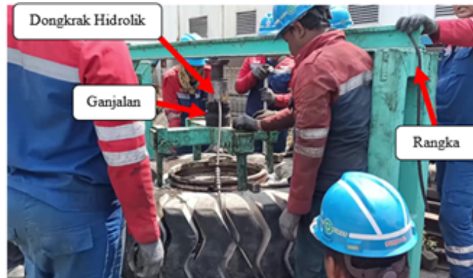
Gambar 1 Proses Pelepasan Velg Ban RTG Crane menggunakan dongkrak hidrolik.
