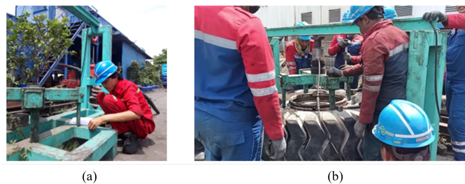
Gambar 6 Observasi Lapangan: (a) Pengukuran Alat Existing, dan (b) Proses Pelepasan Sistem Pengunci Velg..
