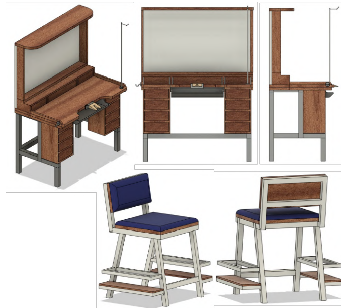
Gambar 9 Desain Final Stasiun Kerja untuk Perajin Perhiasan
