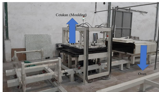
Gambar 6 Peralatan pengolahan limbah plastik menjadi produk Robries.
