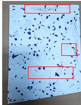
Gambar 3 Contoh produk Robries yang gagal karena adanya shrinkage pada permukaan. Beberapa shrinkage ditunjukkan oleh kotak merah. (Sumber: dokumentasi pribadi)
