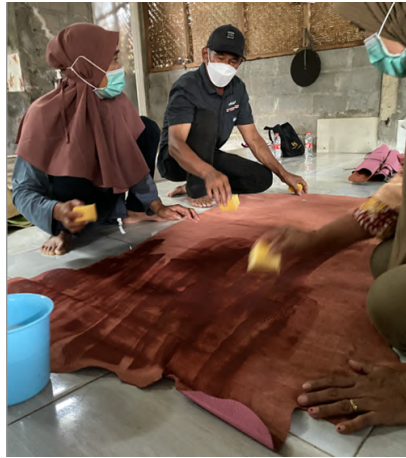
Gambar 7 Pelemasan kulit dengan metode ulas.
