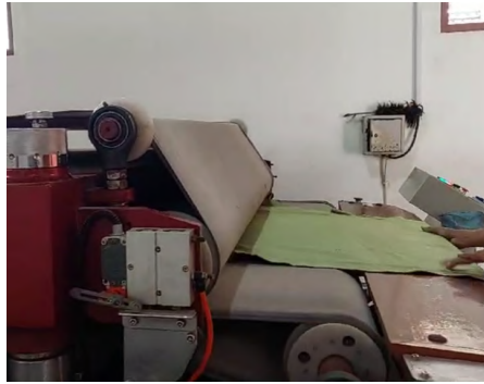
Gambar 3 Proses staking kulit kaku.
