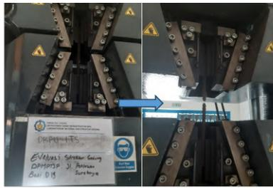
**Gambar 7** Pengujian Tarik Baja.
