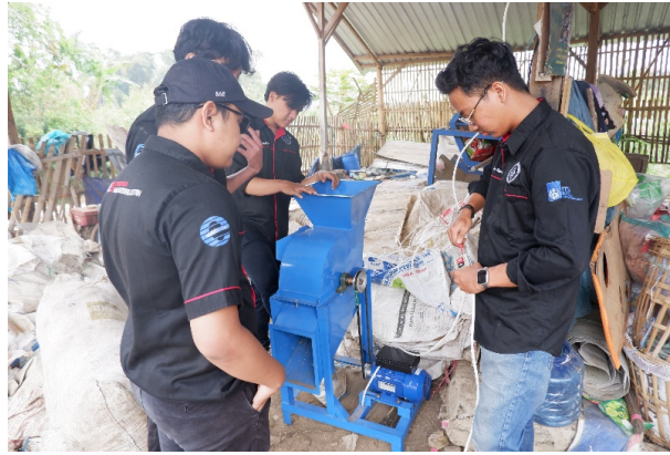
Gambar 14 Instalasi Mesin Pencacah Sampah.
