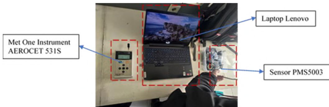
Gambar 4 Skema Pengujian Sensor PMS5003.
