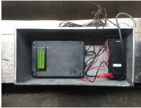
**Gambar 7** Rangkaian alat sensor dan *monitor* yang dilengkapi aki.
