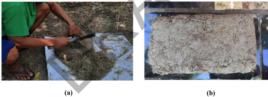
Gambar 8 Eksperimen dengan menggunakan bahan rumput kering: (a) Rumput ilalang yang yang dicacah; (b) Kondisi blok tanah dan rumput ilalang setelah kering.
