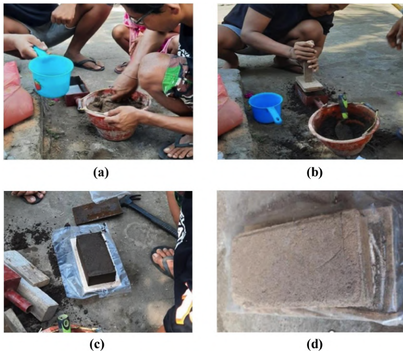
Gambar 5 Proses pelatihan: (a) Mencampur semen dengan tanah; (b) Proses pencetakan dan pemadatan blok; (c) Blok dikeluarkan dari cetakan; (d) Kondisi blok dalam keadaan kering.
