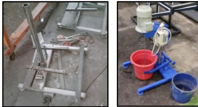
Gambar 7 Proses Manufaktur dan Assembly Mesin Pengaduk.
