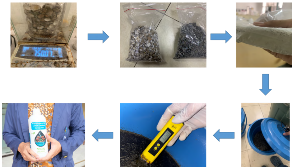
Gambar 2 Tahapan pembuatan pupuk organik cair dari limbah cangkang kerang.
