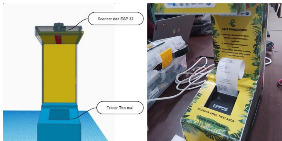
Gambar 5 Desain dan hasil mesin cetak tiket terintegrasi.
