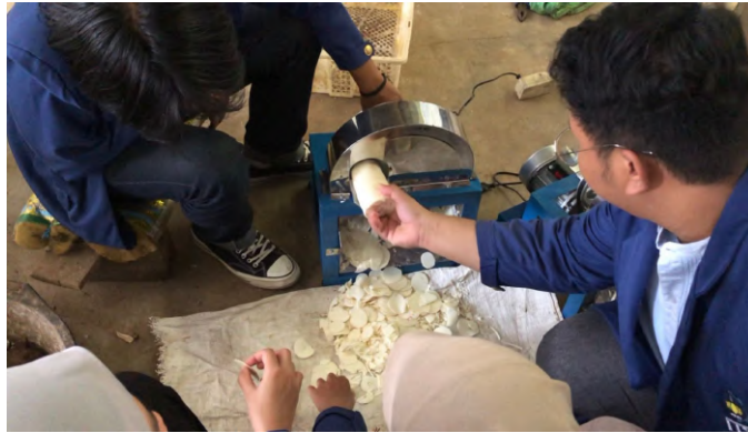
Gambar 11 Percobaan Menggunakan Alat Potong yang Mata Pisaunya telah ter- coating .
