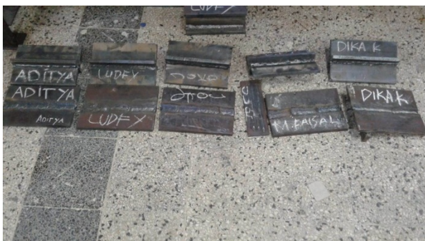
Gambar 14. Sampel hasil pelatihan las dasar lanjut posisi 2G dan 2F
