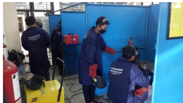
Gambar 13. Praktek las dasar lanjut posisi 2G dan 2F
