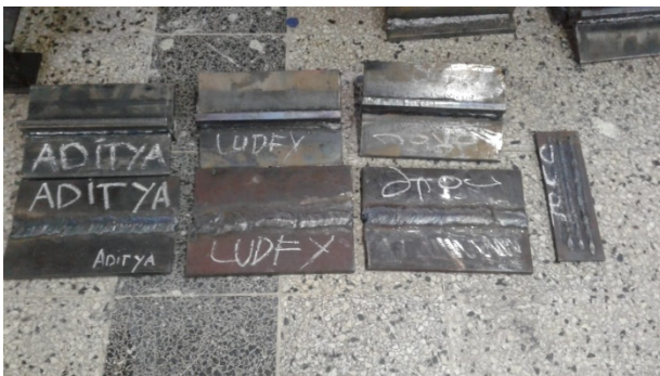
Gambar 14. Sampel hasil pelatihan las dasar lanjut posisi 1G dan 1F
