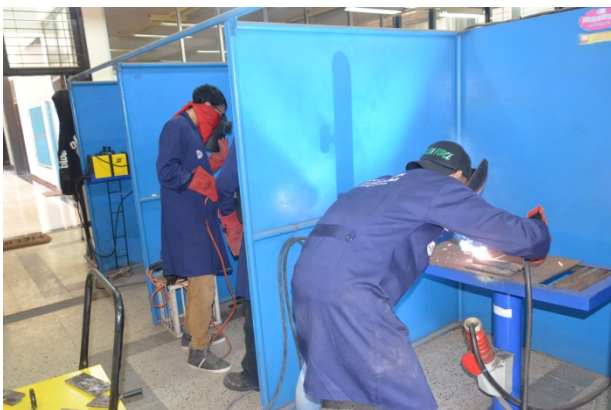
Gambar 3. Peralatan mesin las dan bilik las di Laboratorium Dinamika Struktur Laut dan Material, Departemen Teknik Kelautan, FTK – ITS
