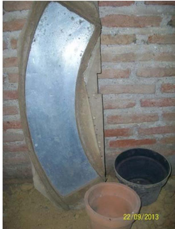
Gambar 2. Busur cetak, alat membuat lempengan pot kembang
