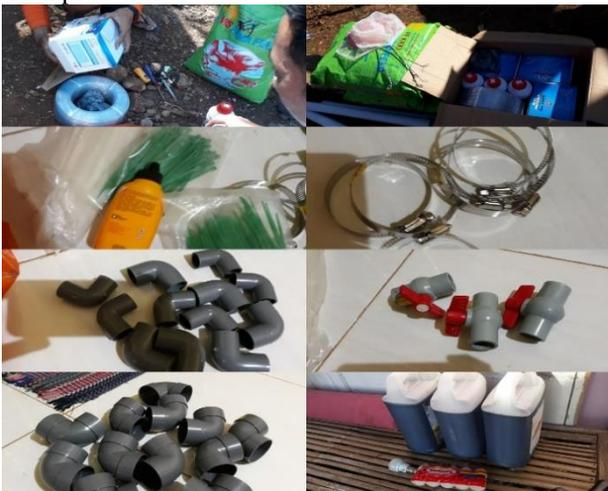
Gambar 15. Alat dan bahan pembuatan unit instalasi kolam
