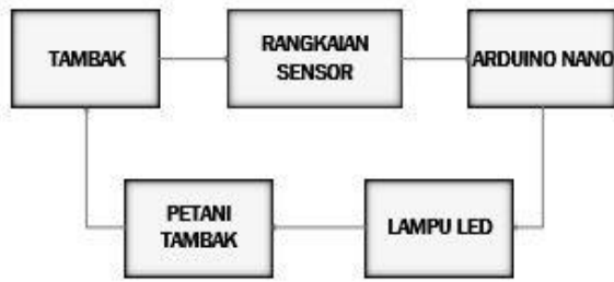
Gambar 2. Diagram blok sistem pengukuran
