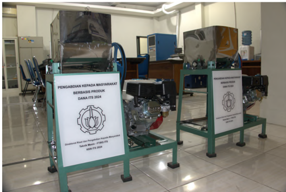
Gambar 4 Dua unit purwarupa mesin pengupas kedelai yang telah selesai diproduksi. Mesin dirancang sesuai dengan kebutuhan IKM pengolah tempe di Desa Sepande dan telah melalui proses fabrikasi meliputi pemotongan, pengeboran, bending , pengelasan, dan perakitan. Kedua unit ini selanjutnya akan diserahkan kepada mitra masyarakat untuk digunakan dalam peningkatan efisiensi proses produksi tempe.
