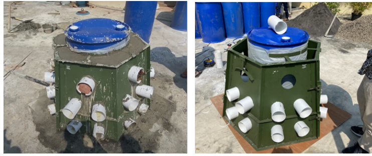
Gambar 7 Proses pencetakan purwarupa terumbu buatan.
