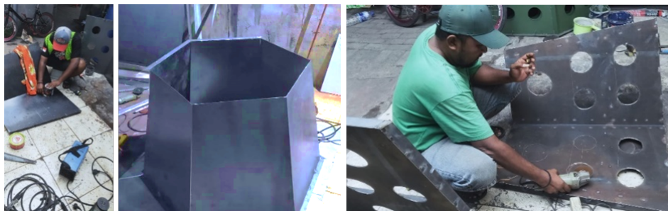
Gambar 6 Proses pembuatan plat cetakan terumbu buatan.
