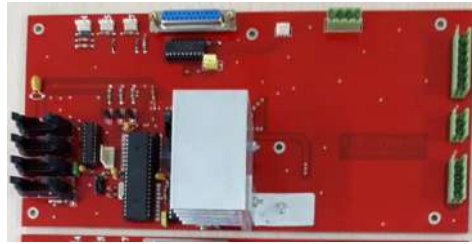
Gambar 10 Realisasi mainboard Mesin Braille.
