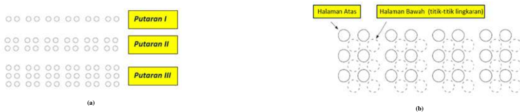
Gambar 4 (a) Matrik titik-titik untuk huruf Braille versi 6 dot (titik); (b) Posisi pergeseran untuk penyesuaian cetakan huruf Braille pada dua sisi kertas.
