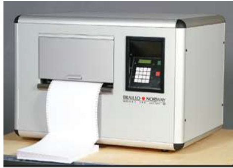
Gambar 1 Mesin cetak Braille, Braillo-200 . [2]
