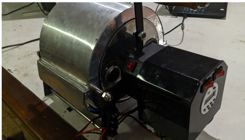
Gambar 9 Mesin pemanggang biji kopi untuk petani kopi desa Rejoagung.
