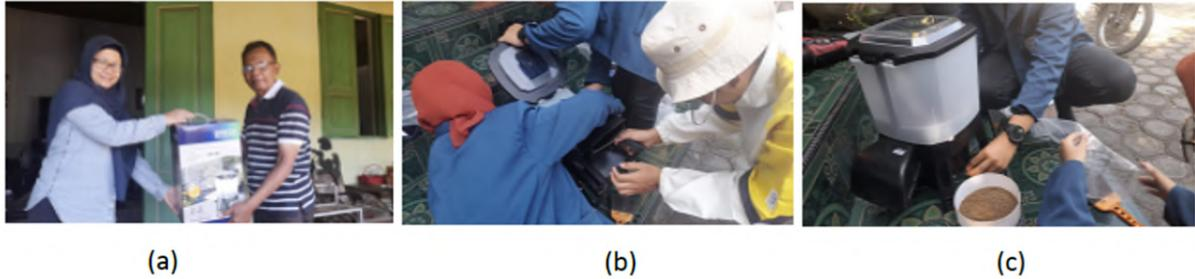
**Gambar 5** (a). Penyerahan mesin otomasi pakan; (b). proses setting mesin otomasi sesuai bobot ikan; (c). dan persiapan pakan ikan pada mesin.
