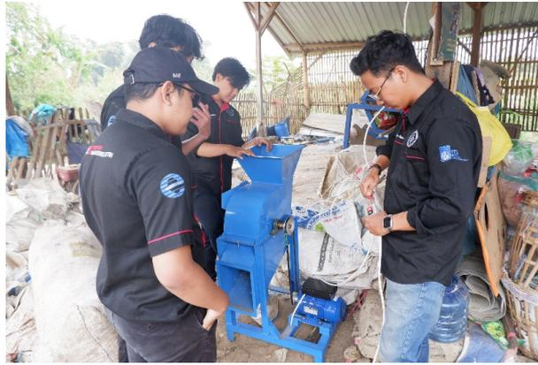
**Gambar 14** Instalasi Mesin Pencacah Sampah.
