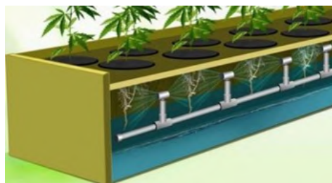
Gambar 2 Sistem tanam aeroponic untuk tanaman umbi-umbian [6] .
