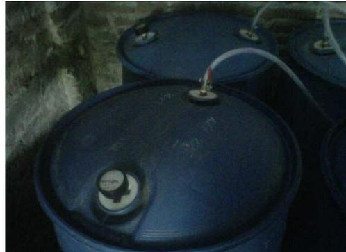
Gambar 5. Drum penghasil gas yang dirangkai dengan selang
