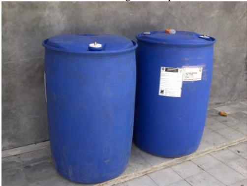
Gambar 3. Drum yang sudah dipasang nosel dan siap diisi kotoran sapi
