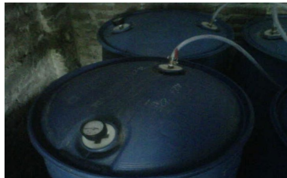
Gambar 16. Ilustrasi pemasangan selang pada digester.
