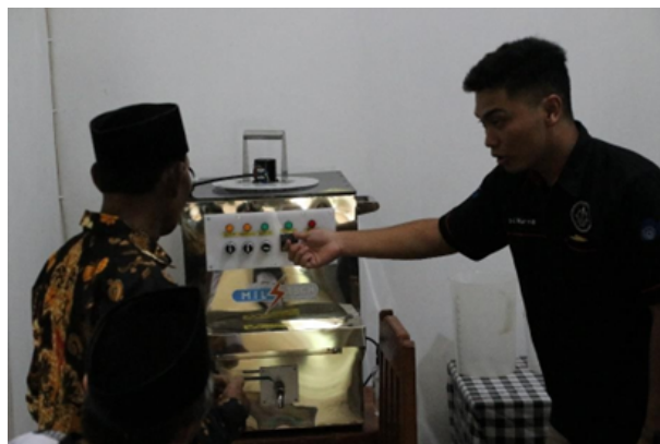
Gambar 8 Uji coba Mesin Pasteurisasi berbasis Kejut Listrik.
