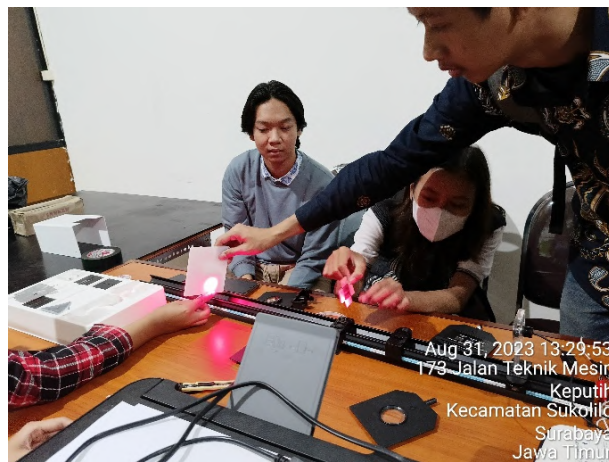
Gambar 4 Pengujian peralatan praktikum interferensi dan difraksi dengan cahaya laser.
